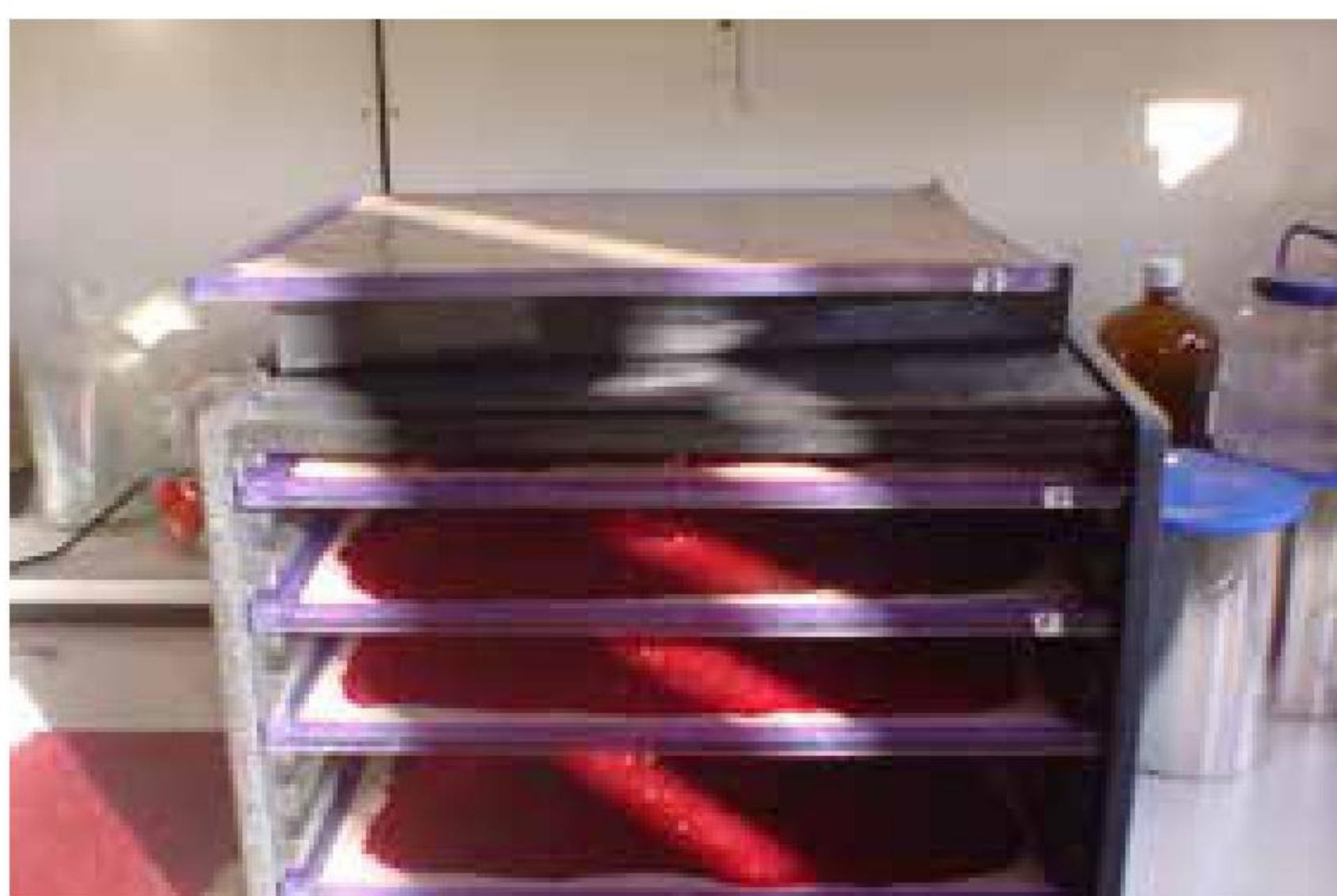
شکل ۲ پالپ‌های انجیر تیغی و سیب؛ خشک‌کن الکتریکی سینی‌دار؛ رول های اکوتیپ رنگی (عکس‌ها از: C. Saenz و A.M. Fabry)
